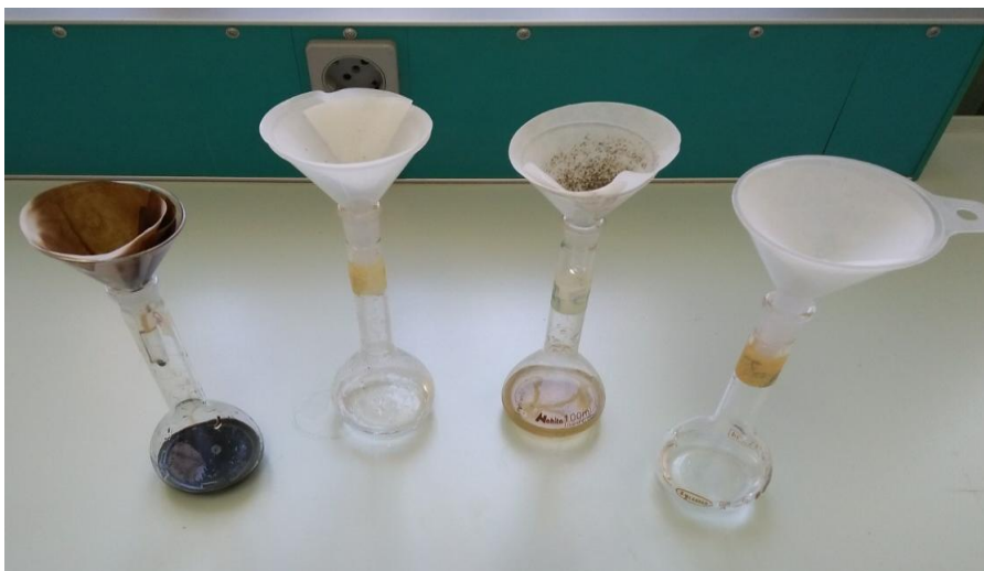
Figure 6 : Etape de la filtration des échantillons
